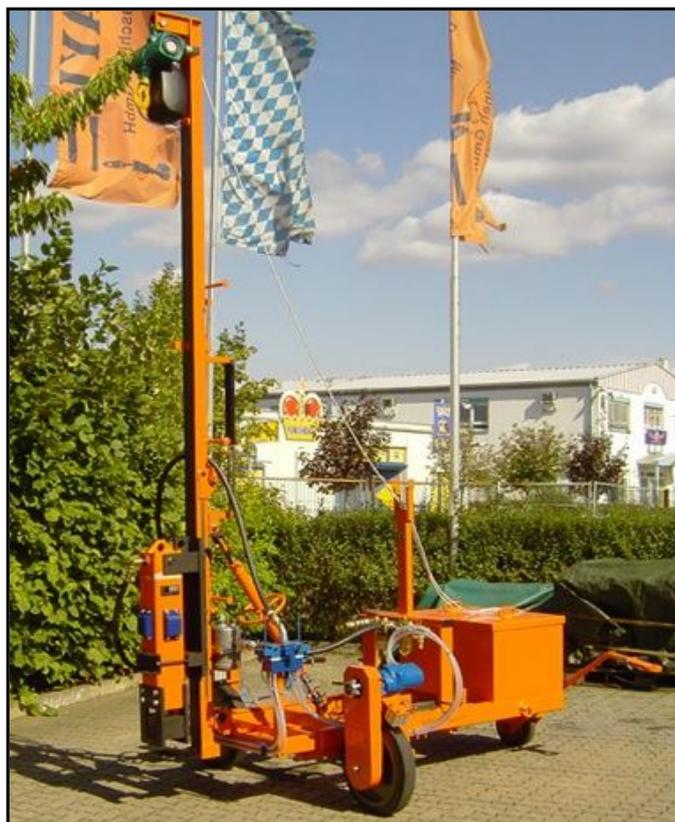
**Пневматическая сваебойная установка LRG** (от нем. Leitpfosten-Ramm-Gerüst) предназначена для забивания свай/столбов при проведении дорожно-строительных работ и характеризуется продолжительным сроком службы в сочетании с низкими эксплуатационными затратами.
