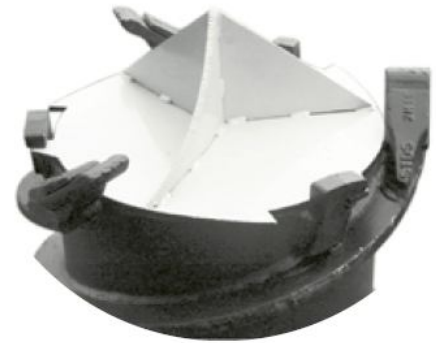
буровой наконечник (3 режущих сектора)
