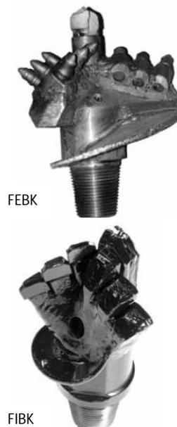
Буровая коронка для скальной породы (тип FEBK) оснащена тремя режущими секторами со сменными резцами и буровой головкой.
