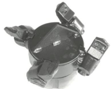
буровая коронка со сменной взаимозаменяемой системой: плоские зубцы AR150 с "теряемой" заглушкой
