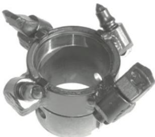
буровая коронка со сменной взаимозаменяемой системой: плоские зубцы AR150 и резцы SLO2, без "теряемой" заглушки
